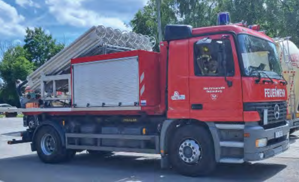
AB-Stickstoffverdampfer der BF Regensburg
