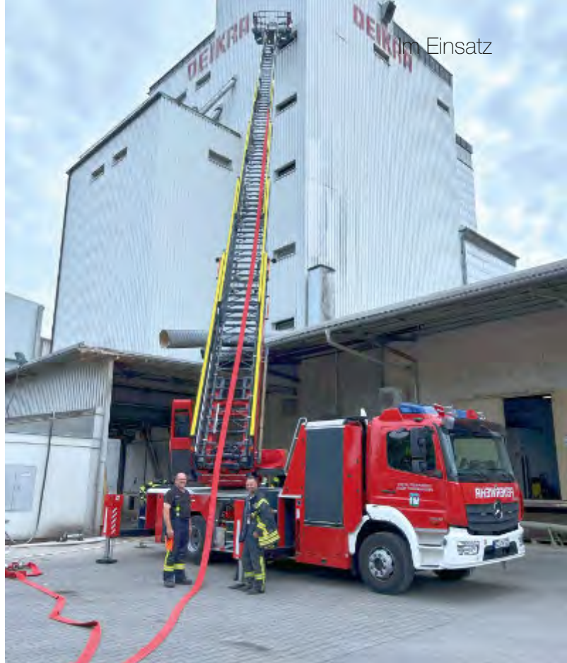
In der Erstphase wurde über die Drehleiter eine C-Leitung in den 7. Stock verlegt.
